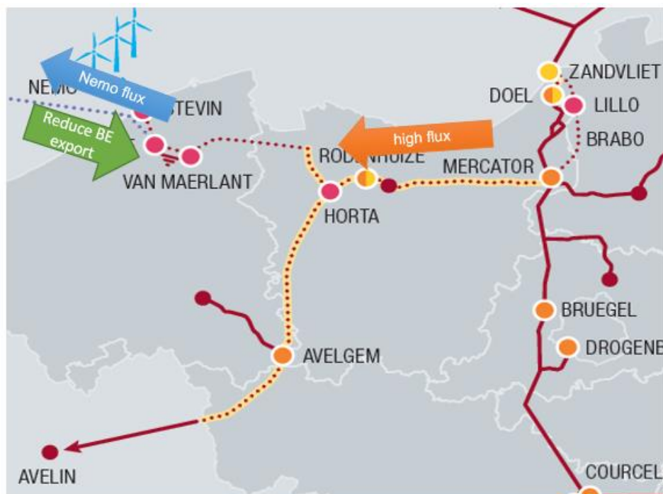
Figure 7 : état du réseau dans la Situation 3
