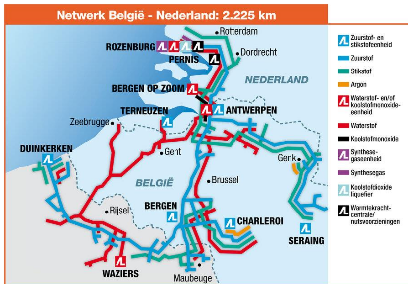
Figure 1 : Réseau intégré de canalisations d'Air Liquide en France-Benelux. Les conduites rouges transportent l'hydrogène. https://industrie.airliquide-benelux.com/belgique-luxembourg/carte-reseau-canalisation-air-liquide-benelux
