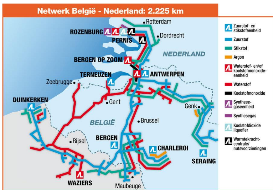
Figuur 1: Geïntegreerd pijpleidingennetwerk Air Liquide in Frankrijk-Benelux. De rode pijpleidingen vervoeren waterstof. https://industrie.airliquide-benelux.com/belgie-nederland/kaart-netwerk-pijpleidingen-air-liquide-benelux
